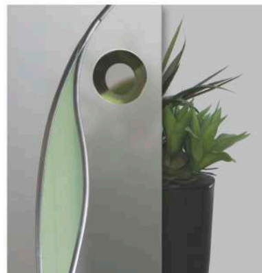
DEKORATIVNO VITRAJ STAKLO S FAZETOM I FOLIJOM - unutarne staklo je satinato, na koje je nalijepljena fazeta na rubovima je folija - 5 boja i obostrano obrubljeno olovnom trakom.
