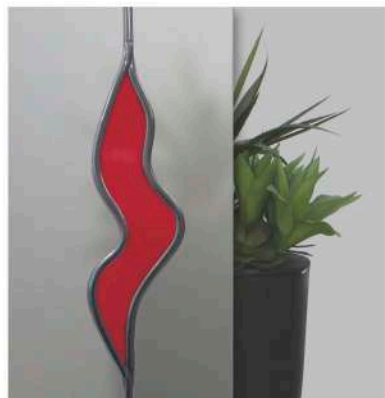
DEKORATIVNO VITRAJ STAKLO S FOLIJOM - unutarne staklo je ornament (katedral ili satinato) s nalijepljenom folijom - 5 boja i obostrano obrubljeno olovnom trakom.
